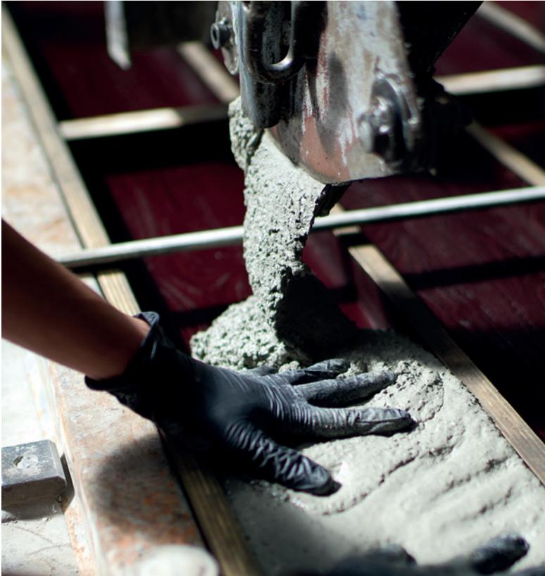
Für unsere Manufakturarbeiten ist Hochleistungsbeton erste Wahl, hier in Form von 100 % selbstverdichtendem Beton (SVB). Der äußerst fließfähige Werkstoff ist wie geschaffen für perfekte Sichtbetonoberflächen auch bei diffizilen Schalungsgeometrien. Ob großformatig oder kleinteilig: Jedes Ausschalen bringt ein optisches Erlebnis hervor.
