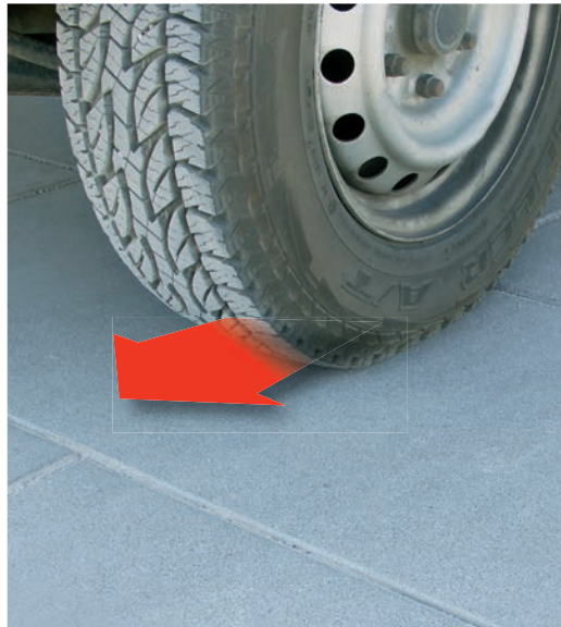
Abb. 59: Radaufstandsfläche auf einer Platte mit auftretenden Horizontalkräften
