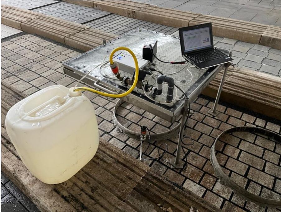
Abbildung 6: Infiltrationsmessung auf dem Pflasterbelag
