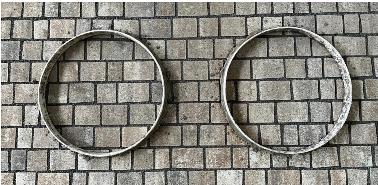
Abbildung 3: Das Testfeld mit auszementierten Test-Ringen (kleines Format)
