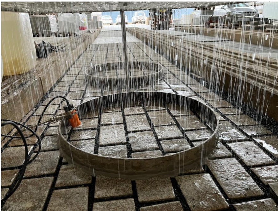
Abbildung 7: Infiltrationsmessung auf dem Pflasterbelag
