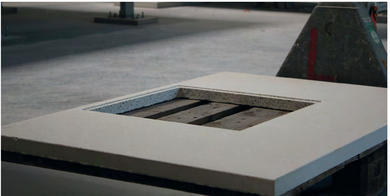
Präzisionsgefräster Ausschnitt für eine Küchenarbeitsplatte
